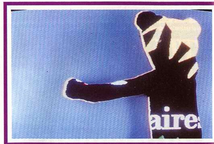
Découpe en chrominance sur fond bleu, inversée. La source vidéo apparaît sur le sujet. Seule la couleur de fond de la source vidéo n'est pas transparente.
