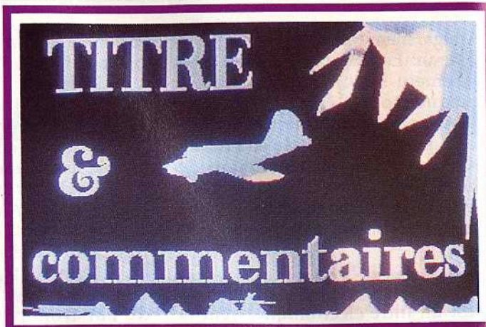
Incrustation inversée. L'image Amiga forme un masque sur la source vidéo. Seule la couleur de fond de l'Amiga n'est pas transparente.
